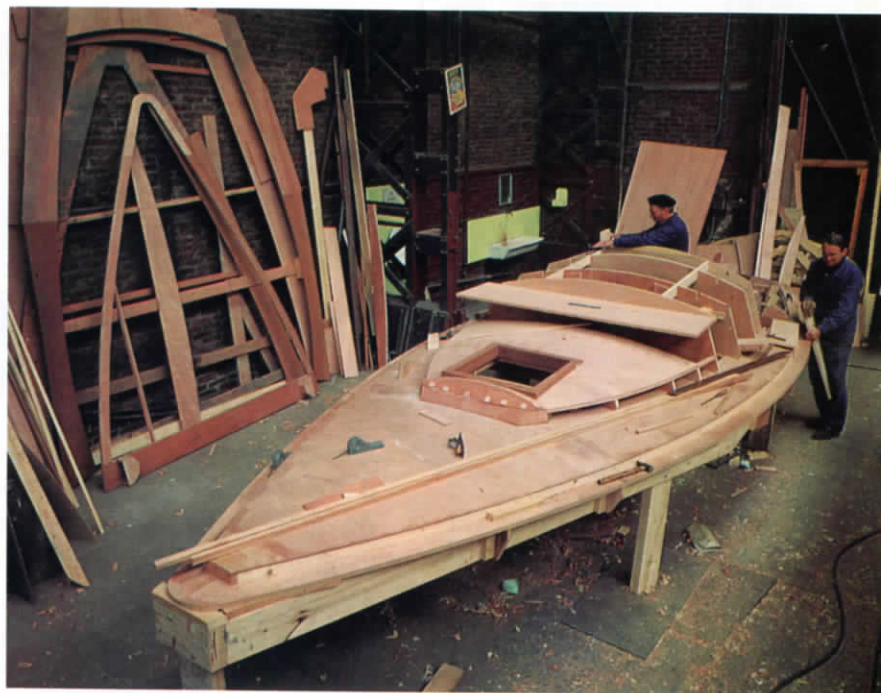
Prototype en contreplaqué marine (type NAVYREX) servant à la réalisation des moules.
